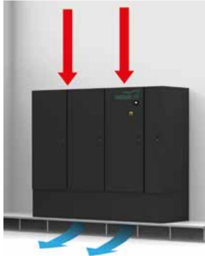
Esecuzione per installazione perimetrale all'interno del data center con altezza del pavimento sopraelevato minore di 550 mm. In questo caso il supporto di altezza fissa 550 mm, fornito di pannelli di chiusura laterali, dovrà essere installato sopra il pavimento. È comunque indispensabile verificare che l'altezza del soffitto permetta una buona aspirazione dell'aria.
