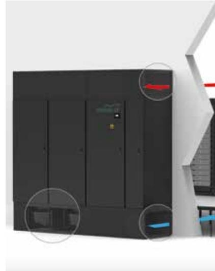
Esecuzione per installazione all'esterno del data center, senza pavimento sopraelevato e mandata posteriore. In questo caso il supporto di altezza fissa 550 mm, è fornito di pannelli di chiusura laterali e griglie di mandata posteriori. L'installazione del plenum con sistema di aspirazione posteriore è opzionale, in mancanza di un sistema di canalizzazione.
